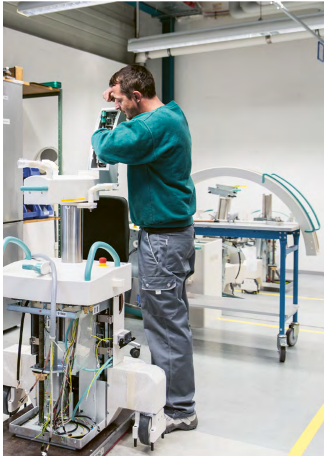
Jeweils ein Mitarbeiter kümmert sich um die Montage eines späteren C-Bogens. Dabei übernimmt er neben der mechanischen auch die elektronische Montage des Fahrstativs.
