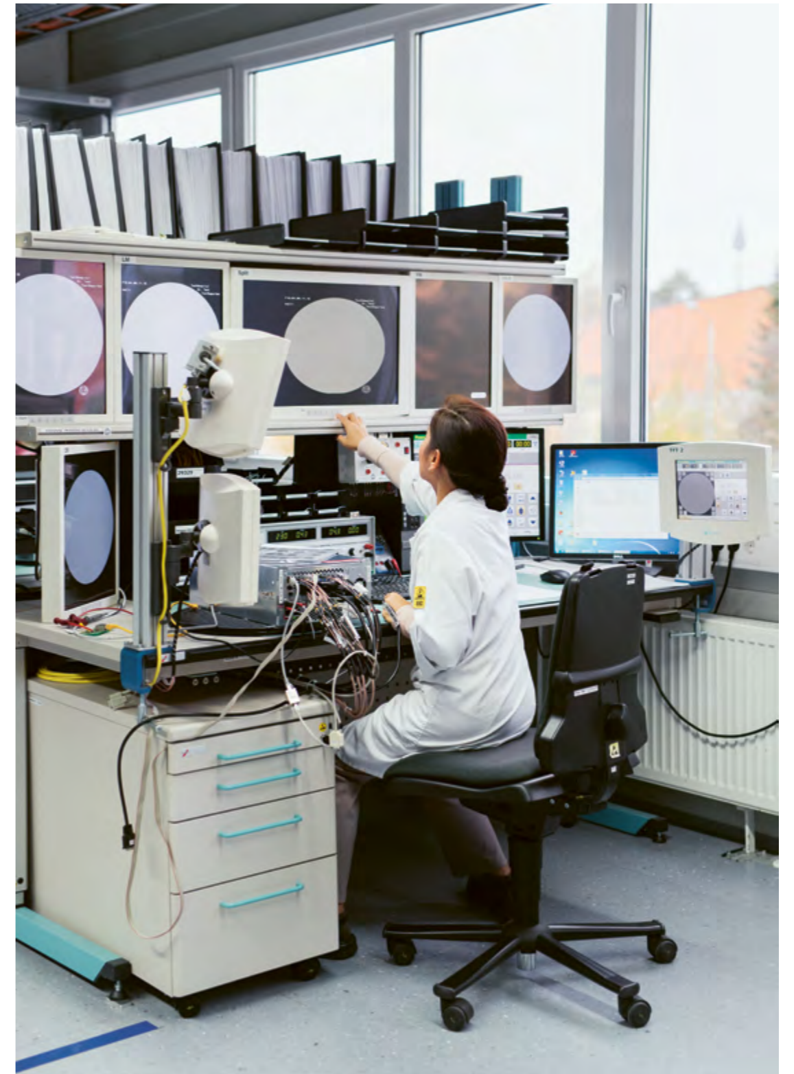
Test und Kalibrierung der Monitore am C-Bogen und Fahrstativ sind essenziell für die zuverlässige Bildgebung im Operationssaal.
