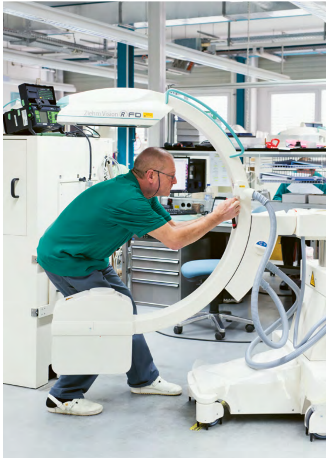
Der fertige C-Bogen wird mit den notwendigen Sicherheitsaufklebern ausgestattet. Letzte Abschlusstests (hinter Bleiglas) für ein 3D-Gerät, bevor es die Reise zum Kunden antritt.
